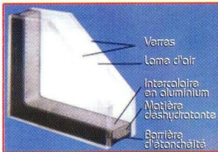
Schéma de principe d'un vitrage isolant
